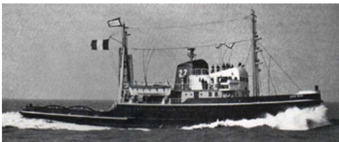
Le remorqueur de haute mer et de sauvetage Jean Bart, mis en service en 1956. Longueur : 53 mètres, deux moteurs totalisant 3 500 CV, une seule hélice. Sa vitesse est de 16 nœuds et sa traction de 32 tonnes. Équipage de 27 hommes
