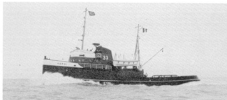
Le remorqueur de port et de haute mer Hardi , mis en service en 1959. Longueur : 30 mètres, deux moteurs totalisant 2 730 CV, une seule hélice. Sa vitesse est de 14 nœuds et sa traction de 30 tonnes. Équipage de 17 hommes.
