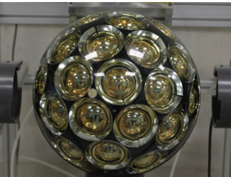
Un module de KM3NeT avec 31 "yeux" sensibles à la lumière (appelés tubes photomultiplicateurs) dans les profondeurs marines.
